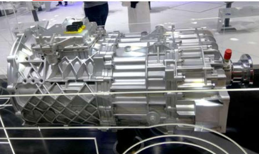
记者，相比手动挡卡车，车队内配装法士特·智行 AMT 变速器的自动挡重卡油耗确实不高，“510 马力的卡车，标载跑两广地区，百公里综合油耗大概在 34 升左右，平均比同马力段的手动挡卡车低 3 升以上。”
